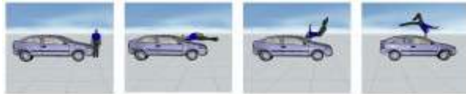
Gráfico 24. Fases del atropellamiento con volteo
